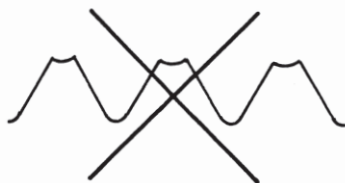
Ø de tournage trop petit Vordreh-Ø zu klein Preturned diameter too small
